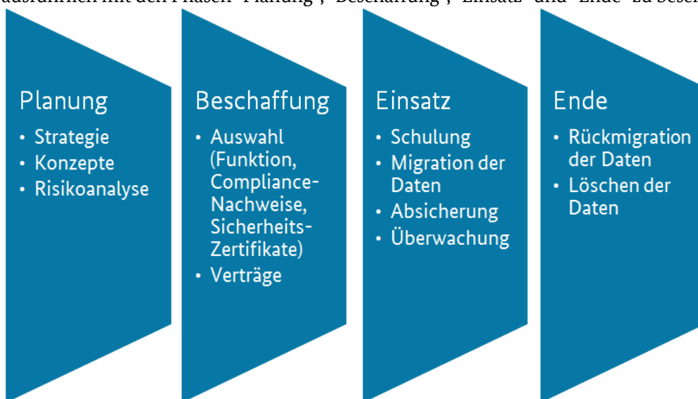
Abb. 8 Lebenszyklus einer Edge-Komponente aus Sicht des Anwenders
